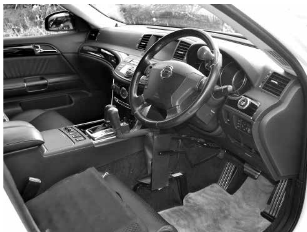
手でアクセル、ブレーキ操作が行えるように改造された自動車
