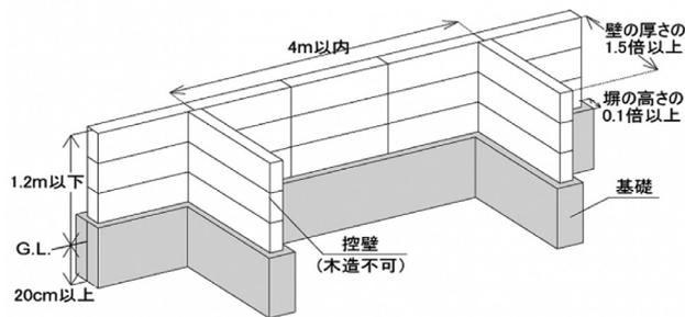
※建築基準法施行令第 61 条による規定内容を図化したものです。国土交通大臣が定めた構造方法により補強され、かつ、国土交通大臣が定める構造計算により構造耐力上安全であることが確かめられた場合についてはこの限りではありません。
