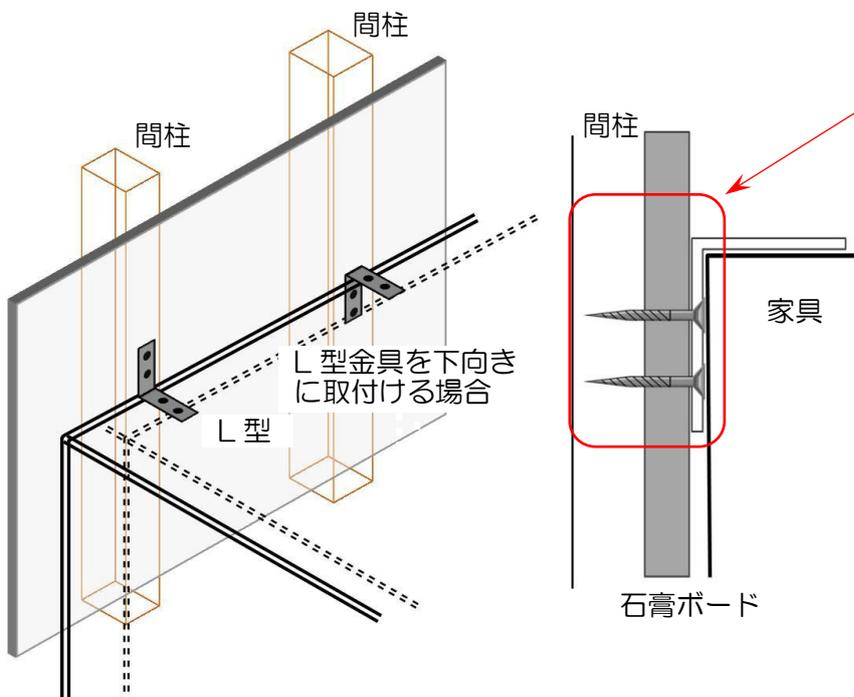
壁にL型金具を用いて固定するには、**間柱など壁の下地材に取り付けることが大切です。**
