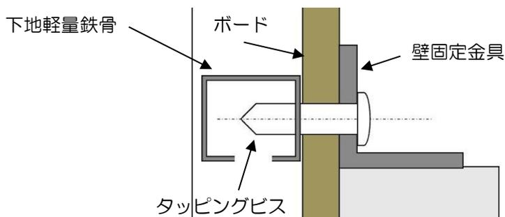
下地軽量鉄骨にはタッピングビス、ボードにはボードアンカーなどを利用して固定します。しかし、コンクリート壁に比べて壁自体の強度が弱いため、どのくらいの強度が確保できているのか確認が困難です。軽量鉄骨下地中空壁への固定は、あくまでも補助的な固定方法と考え、家具の種類やオフィスの環境に応じて、下地補強材などを追加する必要があります。
