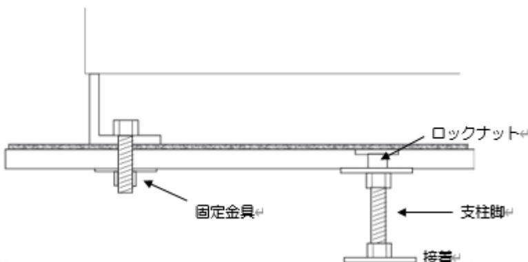
以上の固定方法はいずれも一例であり、フリーアクセスフロアへの固定はメーカーにより異なりますので、メーカーに確認願います。
