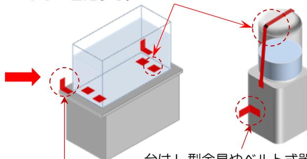
台はL型金具やベルト式器具で壁面に固定する。
