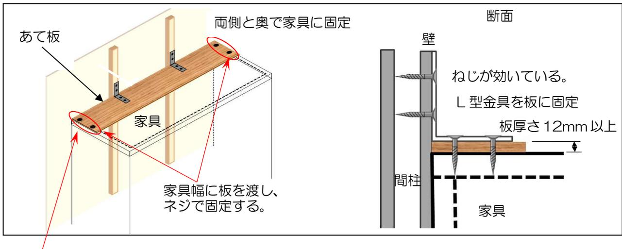
家具の天板の後ろ側にしっかりとした棧の入っていないものは、**家具の幅全体に板を渡しネジ止めしてから**金具を取付けます。
