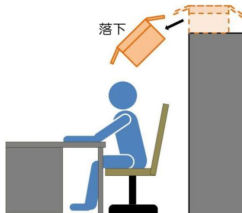
建物の構造体に結合されていないパーティションや間仕切り壁などは、家具を支える十分な強度がなく、壁体や釣り天井の破損につながる危険があるため、重量のある家具類を置かないようにしましょう。重量のある家具類を置く場合は、床固定の併用が必要となります。
