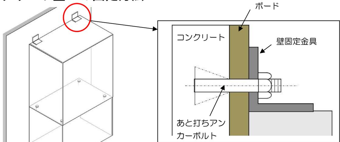
石膏ボードやビニルクロスが仕上材として張られている場合、その下地に強度のしっかりとしたコンクリート壁があれば、コンクリート壁に達するようにアンカーボルトを打ち込み固定します。
