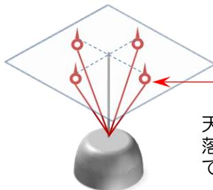
天井にヒートンを打ち、揺れ・落下防止のためワイヤーなどで連結します。
