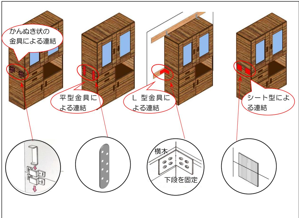
二段重ねの家具類は、**上下を平型金具等で連結**して一体化した上で、家具の固定を行います。連結をしない場合は、上段、下段それぞれを横木等に固定します。
