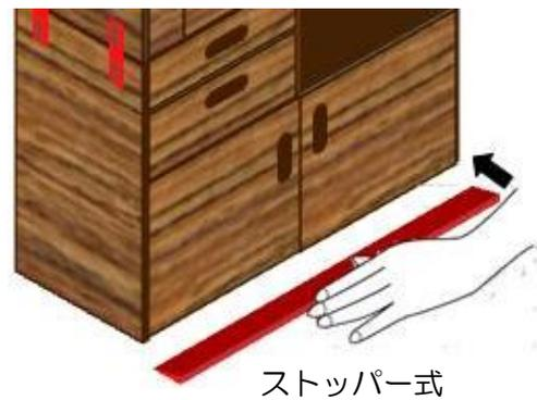
ポール式を使用する場合は、ストッパー式やマット式と併用し、家具の上下に対策を取る。
