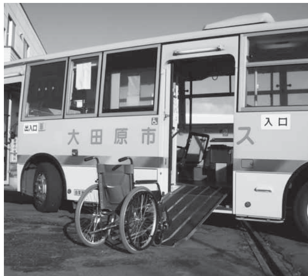
車いす乗降用のスロープが設置されている市営バス
