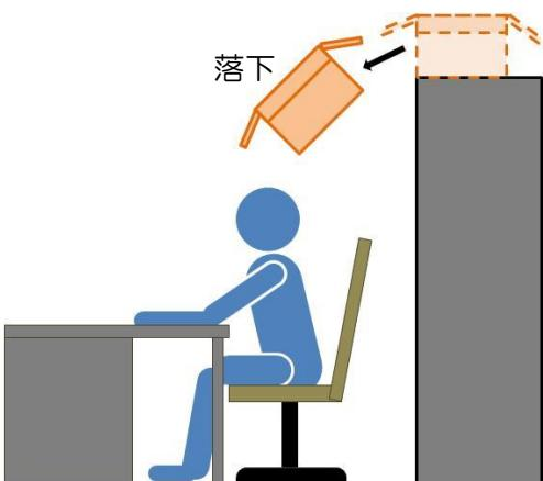
建物の構造体に結合されていないパーテーションや間仕切り壁などは、家具を支える十分な強度がなく、壁体や釣り天井の破損につながる危険があるため、重量のある家具類を置かないようにしましょう。重量のある家具類を置く場合は、床固定の併用が必要となります。
